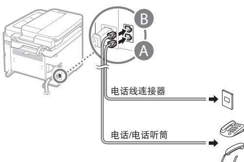
当 <连接电话线路> 出现在显示器上时，请如图所示连接电话线。
